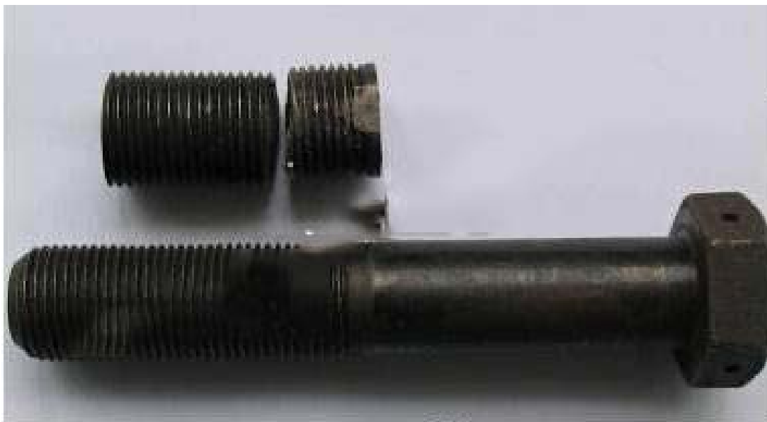
图 2：紧固件发生脆断后
